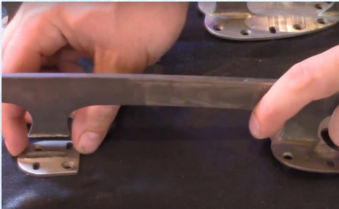
Zadní plošina zatím nepřipájená k noži 1
