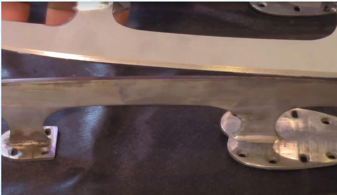
Porovnání spájeného polotovaru a nožem s provedenou povrchovou úpravou (nahore) 1
